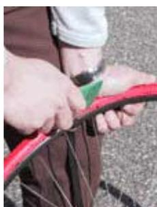
Si nécessaire (pneus route), repousser le talon du pneu entre les crochets de la jante en utilisant la spatule
