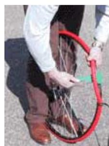
Au fur et à mesure de l'avancement du montage, le pneu increvable est davantage tendu. La position verticale de la roue vous permet de la maintenir en utilisant vos pieds comme points d'appui
